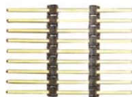
Fig. 4, 18 Pin Header (Alpha p/n: 540-492-19)
